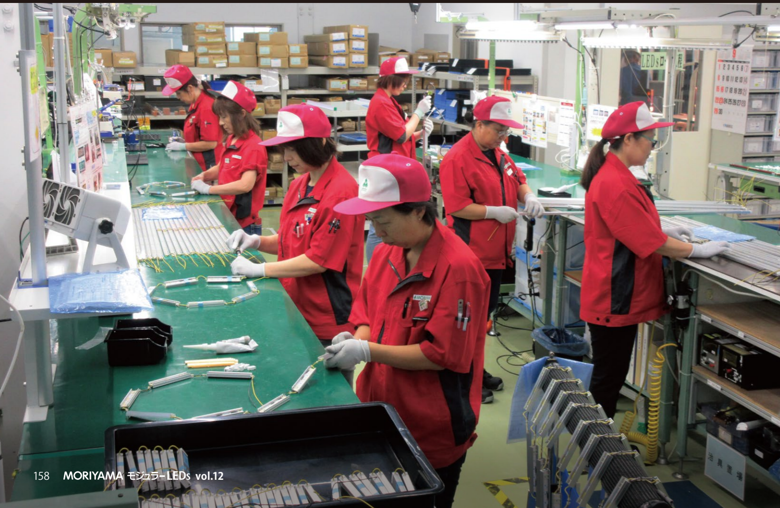
24V製品組立工程 屋内外兼用の製品が主力で、特殊な作業や製品長の種類が多い
