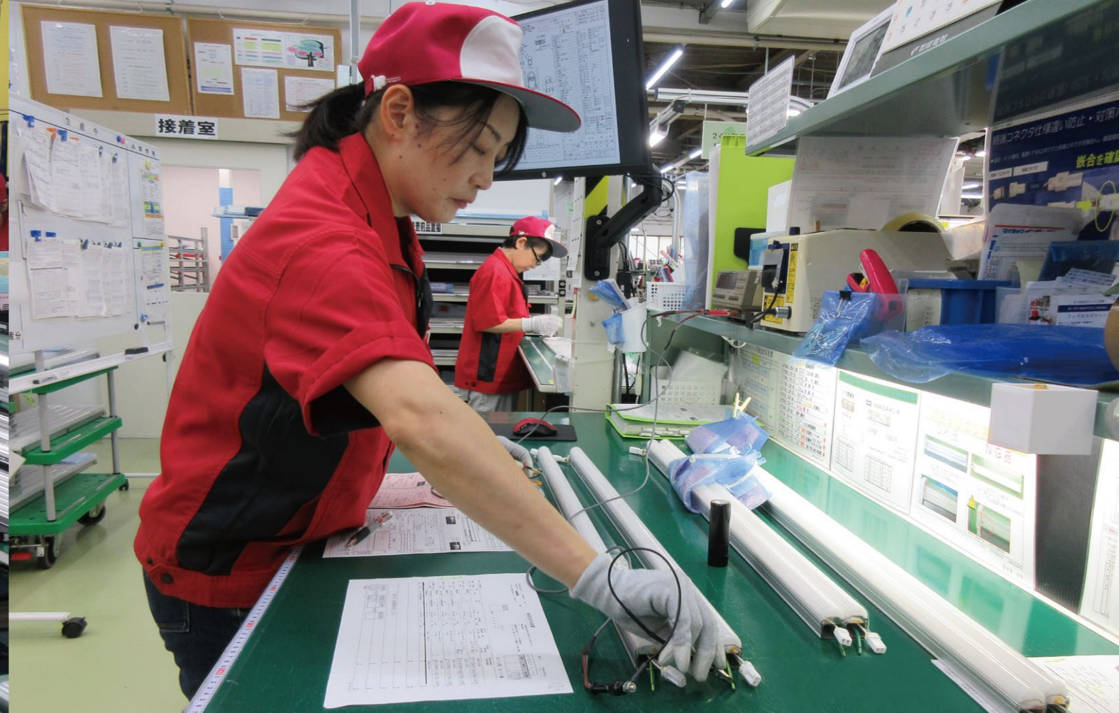
出荷検査工程 確実なチェックにより不良品の流出防止を担う要所
