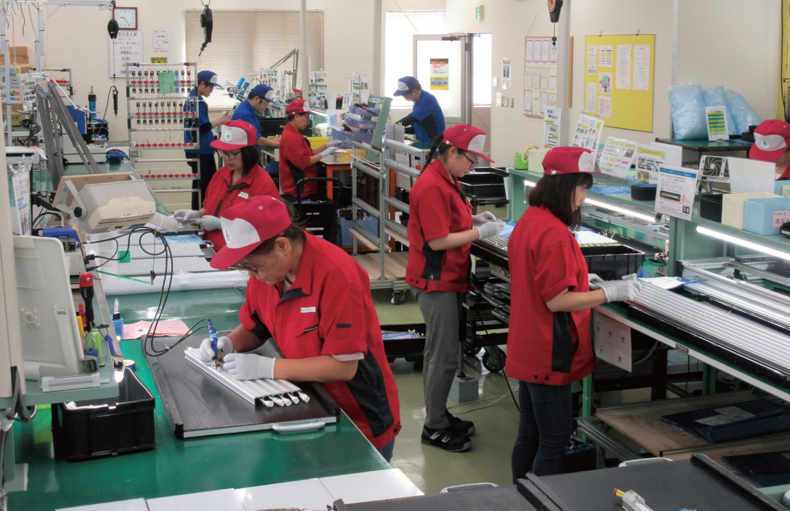
100/200V製品の組立工程 電源内蔵型の防水製品が主力で、部品点数が多く工程も長い
