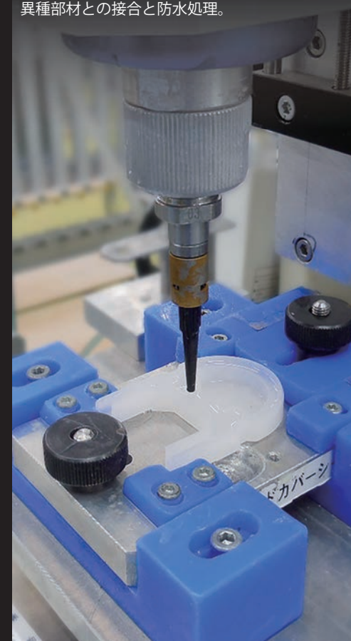
サイドカバーの樹脂塗布 (100V/200V製品)
