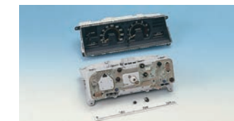
計器板正面と裏面(電球ソケットの実装状態)
