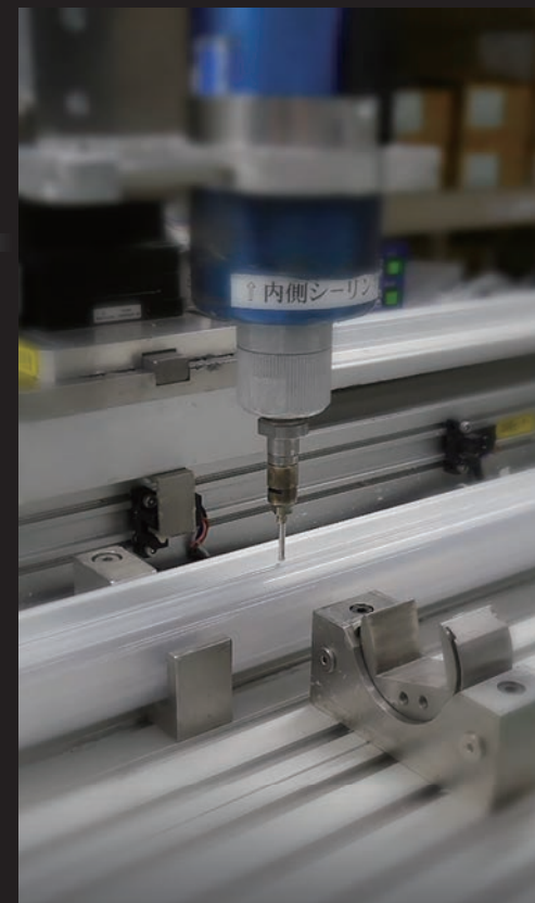
トップカバーの樹脂塗布 (100V/200V製品)
